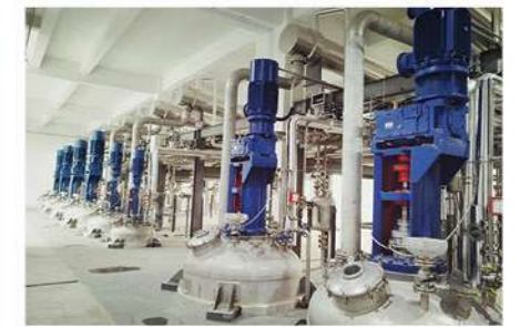
化工搅拌用斜齿轮齿轮箱
