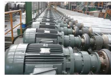
铝辊输送用行星减速机
