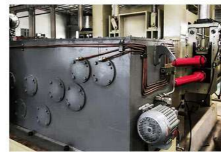
自动金属压机用大型多出轴齿轮箱
