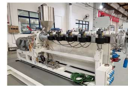
单螺杆挤出机用大型齿轮箱
