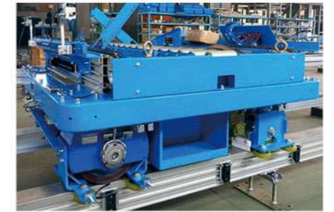
钢板运输用摆线 RGV 减速机
